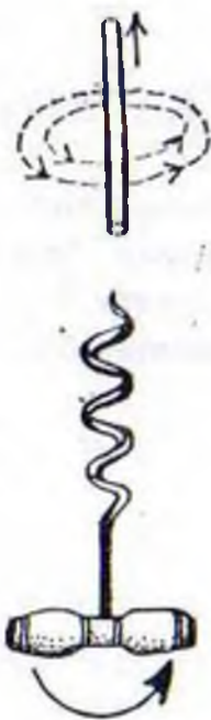
Rys. 13. Przepływ prądu elektrycznego wywołuje powstanie pola magnetycznego wokół przewodnika
