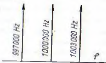
Rys. 92. Fala nośna o częstotliwości 1000 000 Hz modulowana sygnałem małej częstotliwości o wartości 3000 Hz
