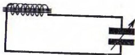
Rys. 60. Obwód rezonansowy, w skład którego wchodzi antena ferrytowa
