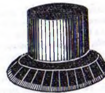
Rys. 28. Gałka kondensatora zmiennego wyskalowana w wartościach pojemności, częstotliwości lub długości fali
