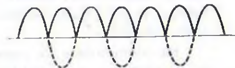
Rys. 109. Linia ciągłą zaznaczono kształt prądu uzyskiwanego w wyniku prostowania dwupółkowego. Linia przerywana pokazuje połówki zatrzymane przez jedną diodę, ale przechodzące przez drugą
