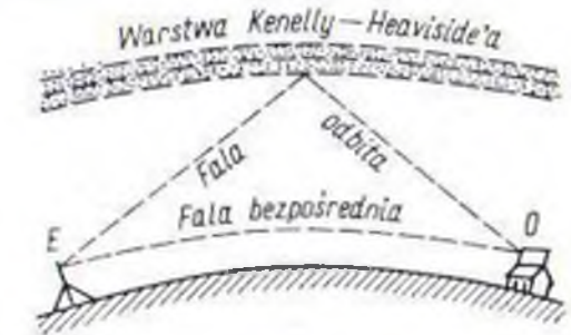
Rys. 112. Fale z nadajnika N do odbiornika O mogą dotrzeć dwiema drogami: bezpośrednio i po odbiciu w górnych warstwach atmosfery od warstwy zjonizowanego powietrza Kenelly-Heaviside'a
