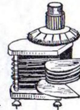
Rys. 28. Gałka kondensatora zmiennego wyskalowana w wartościach pojemności, częstotliwości lub długości fali
